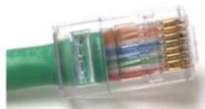
Ordnungsgemäß abgeschlossenes UTP-Kabel
